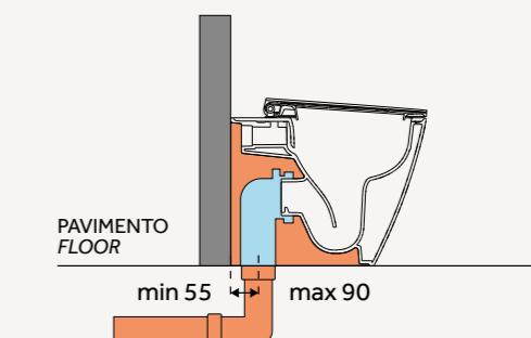
Con lo scarico traslato il pavimento è salvo: sarà sufficiente scegliere la corretta combinazione di curve tecniche e raccordi per installare il vaso senza rompere le piastrelle.
